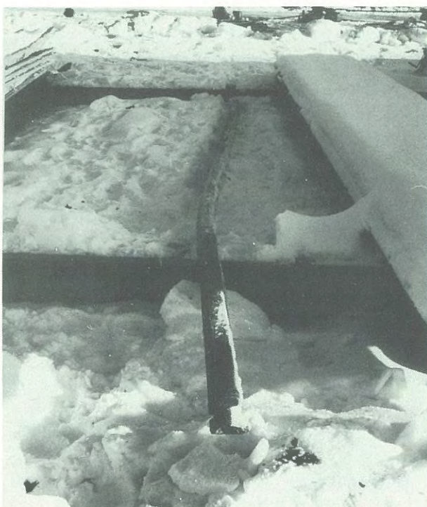
FIG. 29. PÅLE 4 EFTER UPPDRAGNING
